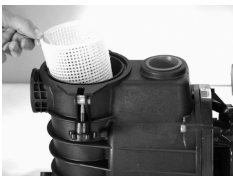
Tägliche Reinigung des Filterkorbes!
