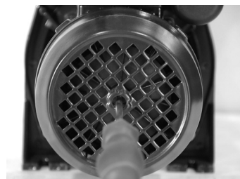
Vor Inbetriebnahme und längerem Stillstand die Achse durch den Lüfter drehen um Gleitringdichtungssperre zu verhindern.
