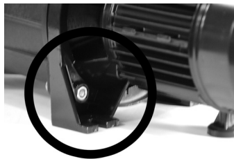
Verificar regularmente la estanqueidad! (Una fuga por el sello mecánico provoca daños importantes!)
